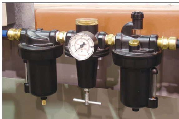
Les FRL de type standard se connectent à l'aide de raccords en laiton
